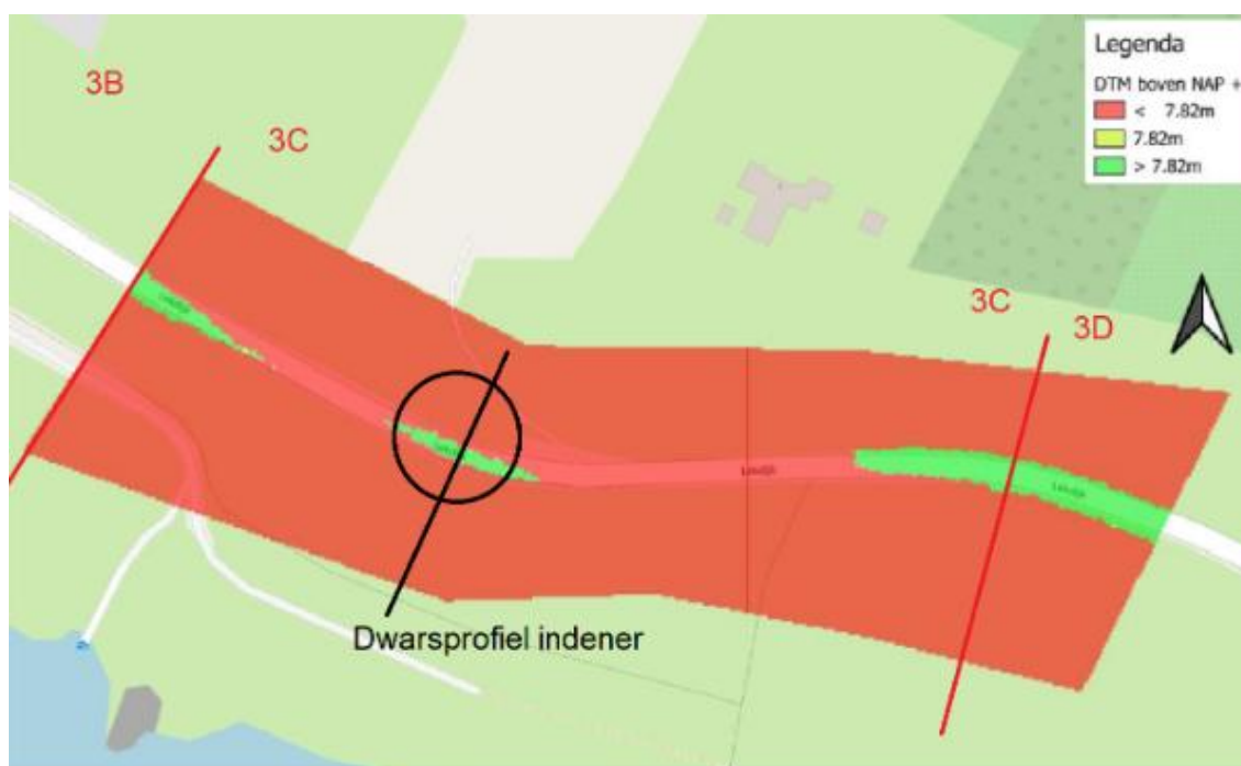
Figuur 2 Fail pass analyse kruinhoogte HBN 1 l/s/m 2073 minus 5 cm (rood = voldoet niet)
