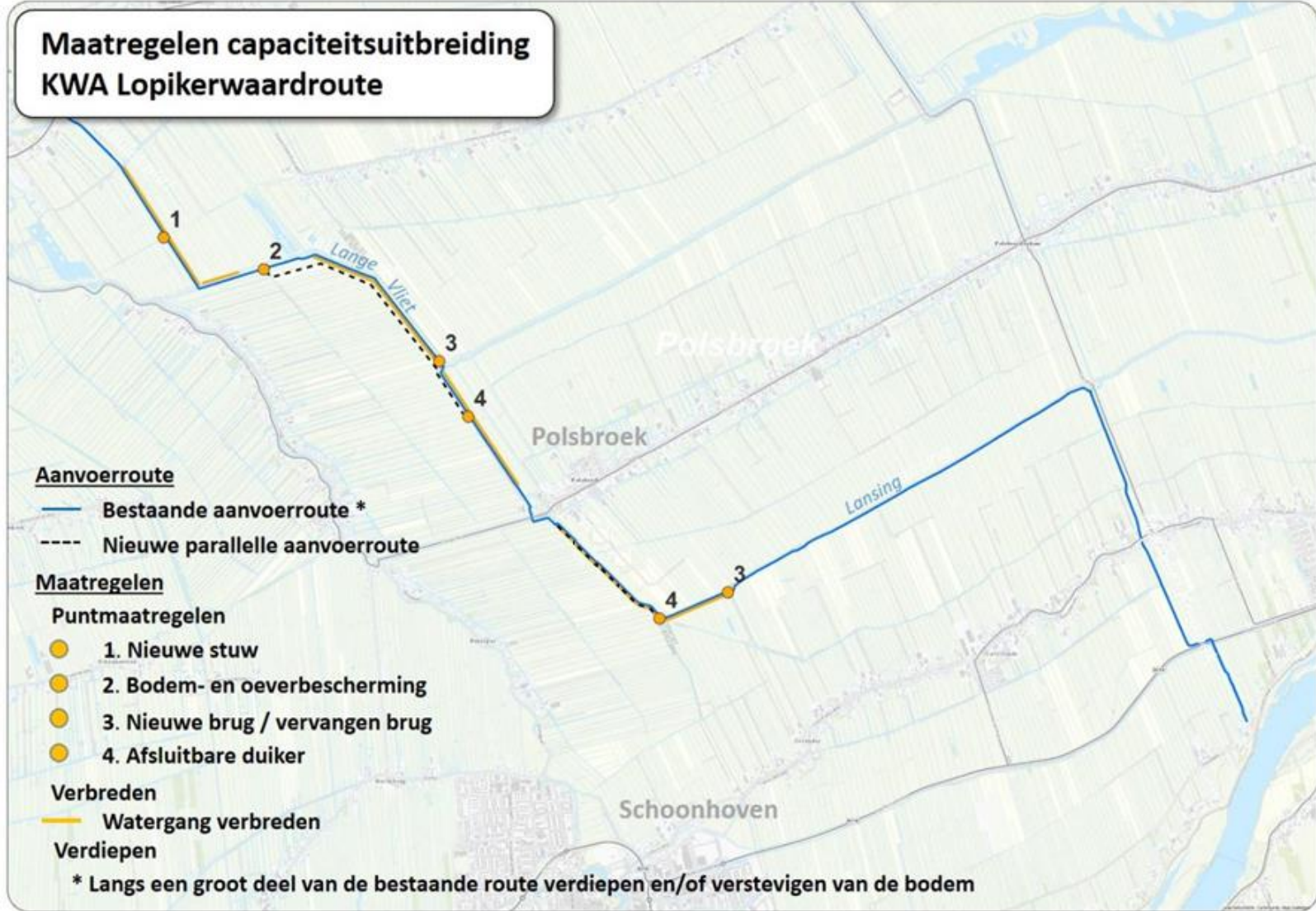
Figuur 5 Type maatregelen in het traject Lopikerwaard. Het verdiepen en verstevigen van de bodem vindt plaats op veel plekken van Lange Vliet t/m Lansing
