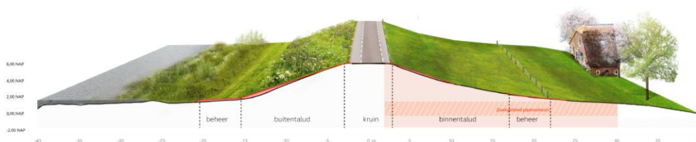
Figuur 3.2: Dijkzone Polder de Wiel: pipingmaatregel in combinatie met beheermaatregelen
