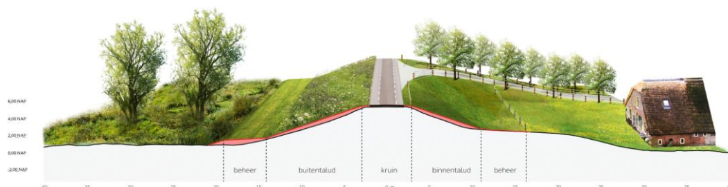
Figuur 3.5: Dijkzone de Bol: Beperkte kruinverhoging en taludverflauwing in combinatie met beheermaatregelen
