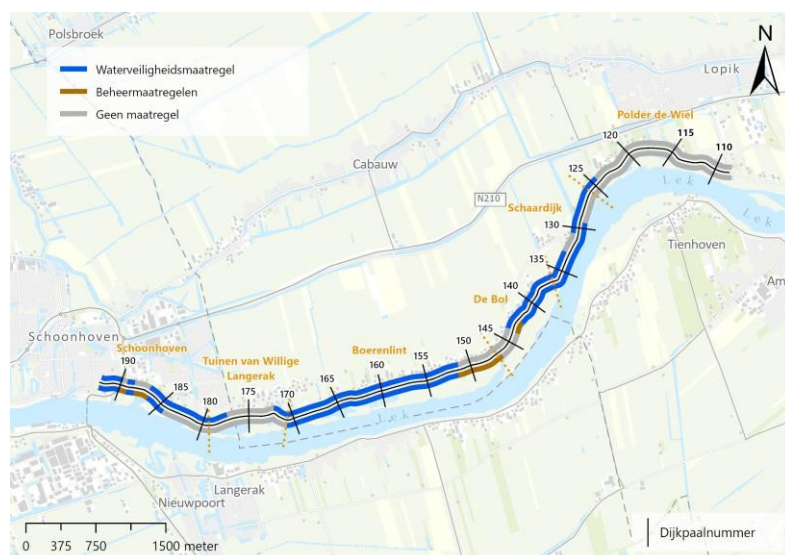
Figuur 2 Overzicht waterveiligheids- en beheermaatregelen (Bovenste lijn: binnenzijde dijk. Onderste lijn: buitenzijde dijk).
