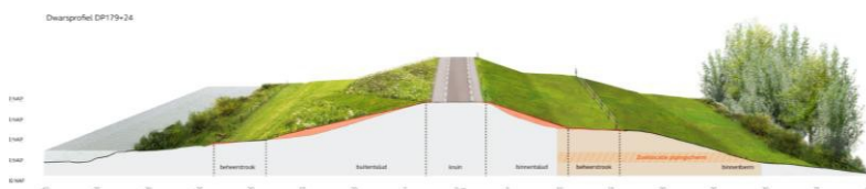
Figuur 3-8 DP180 Pijpscherm in combinatie met beheermaatregelen
