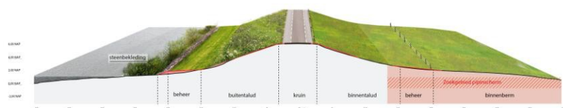
Figuur 3-4 DP 135+7 Pipingscherm en taludverflauwing naar 1:3 in combinatie met beheermaatregelen
